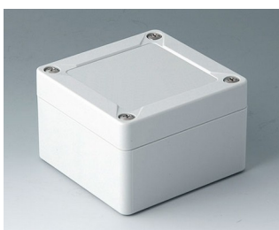
C7008011 IN-BOX АБС (UL 94 HB) светло-серый RAL 7035 84x82x55mm IP 66, IP 67, IK 07
