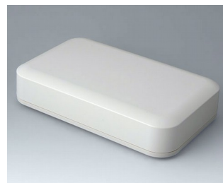
A9481107 EVOTEC 250, исп. I АСА+ПК-ФР (UL 94 V-0) белый RAL 9002 250x155x54mm IP 65 opt., IP 40
