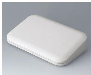
A9465107 EVOTEC 200, исп. II АСА+ПК-ФР (UL 94 V-0) белый RAL 9002 200x124x45mm IP 65 opt., IP 40
