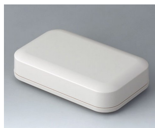
A9441107 EVOTEC 150, исп. I АСА+ПК-ФР (UL 94 V-0) белый RAL 9002 150x93x35mm IP 65 opt., IP 40
