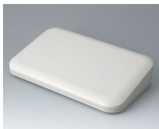
A9485107 EVOTEC 250, исп. II АСА+ПК-ФР (UL 94 V-0) белый RAL 9002 250x155x54mm IP 65 opt., IP 40
