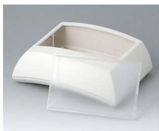
B7025147 ERGO-CASE L, высокий ABC (UL 94 HB) белый RAL 9002 150x200x69mm IP 40
