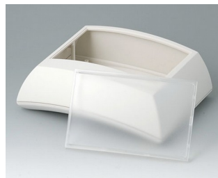
B7025247 ERGO-CASE L, высокий ABC (UL 94 HB) белый RAL 9002 150x200x69mm IP 40
