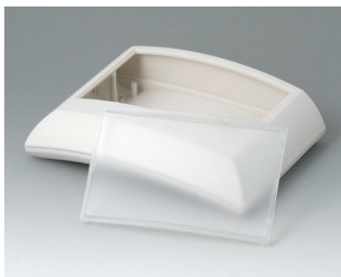
B7020147 ERGO-CASE L, плоский АБС (UL 94 HB) белый RAL 9002 150x200x54mm IP 40
