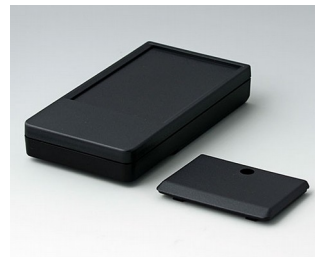
A9072219 DATEC-POCKET-BOX L АБС (UL 94 HB) черный RAL 9005 120x65x22mm IP 54
